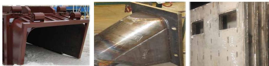
Металлоизделия, термостойкие кузова, водоохлаждаемые кессоны. Для улучшения эксплуатационных характеристик в конструкции применяются термостойкая нержавеющая сталь и медь.
